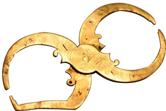
Autre modèle d'un compas huit de chiffre, datant lui aussi du XVIII e siècle, en laiton finement travaillé
