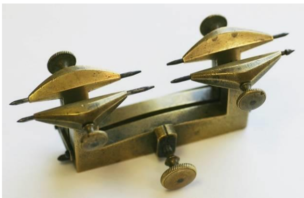
Petit compas aux engrenages, instrument en laiton avec axes en Acier
