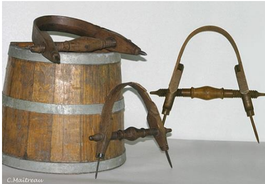
3 compas dits « Bourguignon » de taille différente, ces compas datent pour certains du XVIII e siècle, et ont traversé les siècles grâce à leur utilisation constante de génération en génération.
