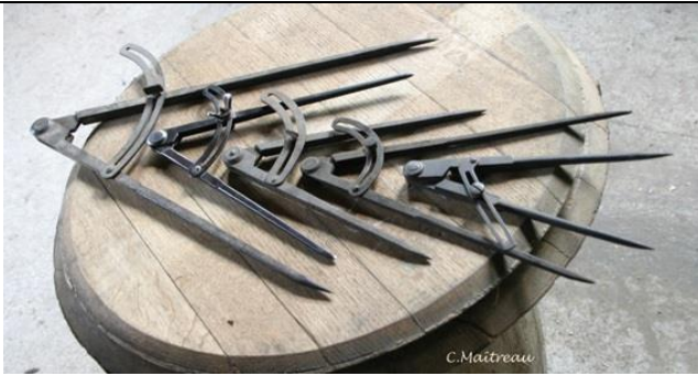
Série de 5 compas en fer avec secteur, utilisé par Janic Sauvion , mais peut être utilisé par un tailleur de pierre, mécanicien, menuisier. De nos jours les compas en fer se généralisent pour plusieurs métiers au détriment d'instruments spécifiques.
